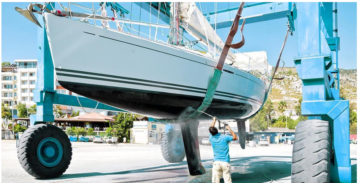
3. ábra Új hajó viaszrétegének eltávolítása
